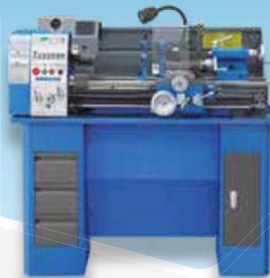
CON SCATOLA INGRANAGGI SEMI NORTON, CAMBIO VELOCITÀ A CINGHIA, AVANZAMENTI LONGITUDINALI, TRASVERSALI, BARRA DI TORNITURA, BANCO PARZIALMENTE, ASSEMBLATO CON 3 CASSETTI E ARMADIETTO
