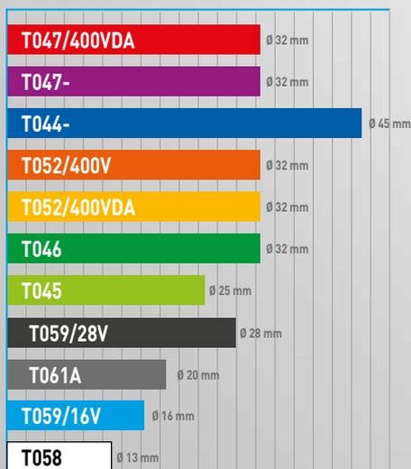
**CAPACITÀ DI FRESATURA**
