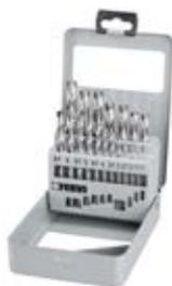
**P023/25****SERIE PUNTE ELICOIDALI CILINDRICHE**DESTRE, SERIE CORTA, RETTIFICATE, PER LAVORAZIONE DI MATERIALI CON RESISTENZA R= 800 N/mm<sup>2</sup>, DUREZZA PUNTA HV= 770 ÷ 830
